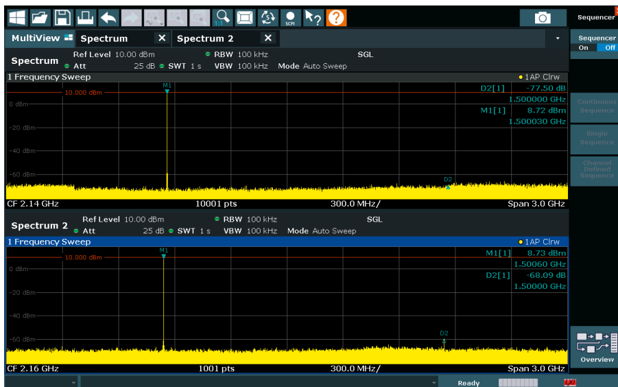
高通滤波器开启 (顶部) 和关闭 (底部) 时的谐波测量
